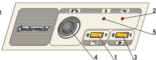
1. ВЫКЛЮЧАТЕЛЬ ГОРЕЛКИ
