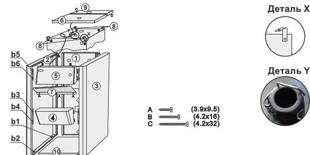
1. Прикрепите держатели изоляции (8) винтами 4,2x16 в отверстия на верхней стороне корпуса котла.
