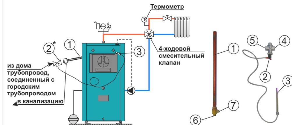
\* Положение термического вентиля после монтажа: (головкой вентиля вниз)
