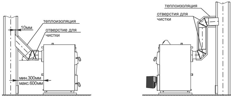
Возможный способ подключения котла ЕКО-СК Р к дымовой трубе (рекомендация).
